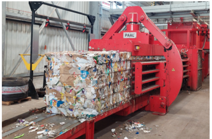
Conditionnement des matières triées en balles
