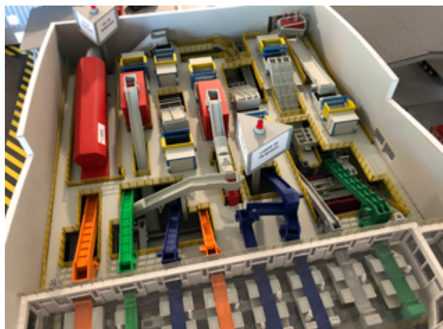
Crible balistique : tri entre les corps creux et les corps plats
