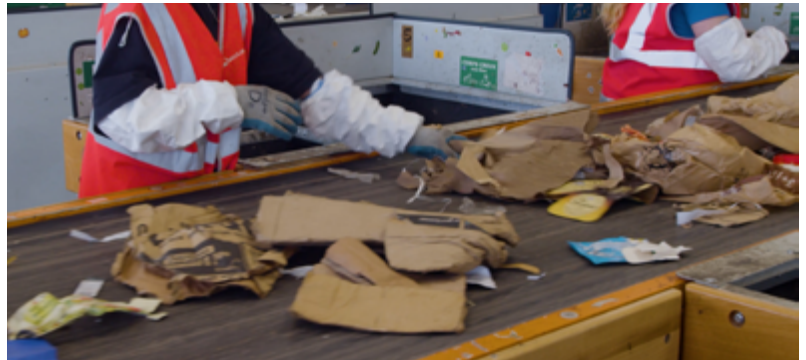
Cabine de tri : contrôle de la qualité des flux triés préalablement par les machines
