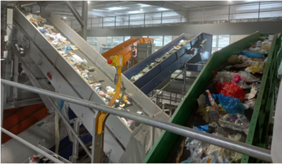
Tapis (convoyeurs) sur lesquels circulent les emballages et les papiers tout au long du process de tri
