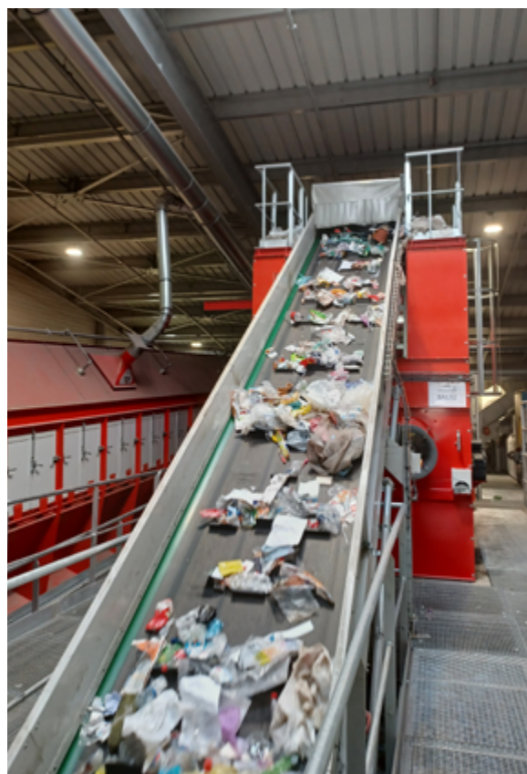
Crible balistique : tri entre les corps creux et les corps plats
